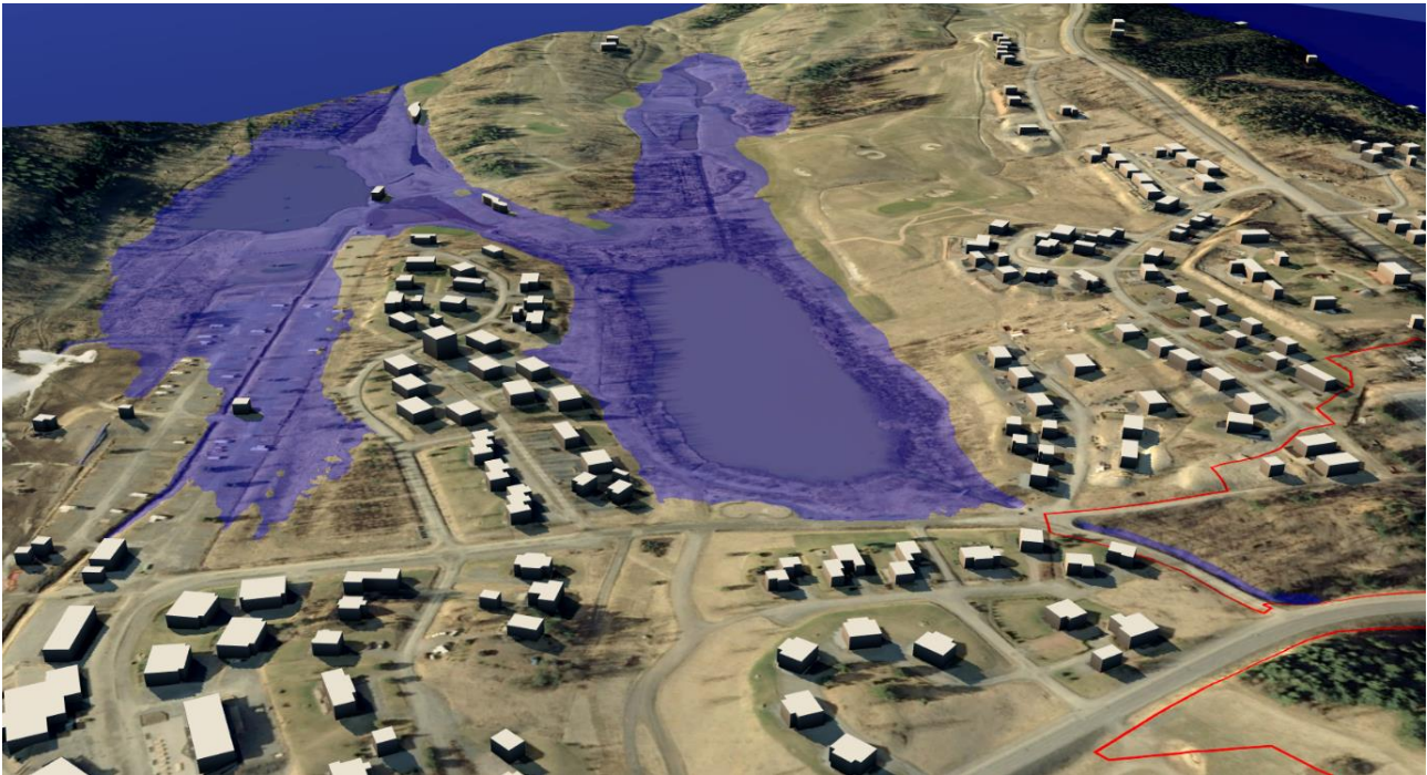
Kuva 32: Veden teoreettinen leviäminen tulvatilanteessa maastomallin avulla arvioiden (Civil3D, korkeusaineisto ©MML)
