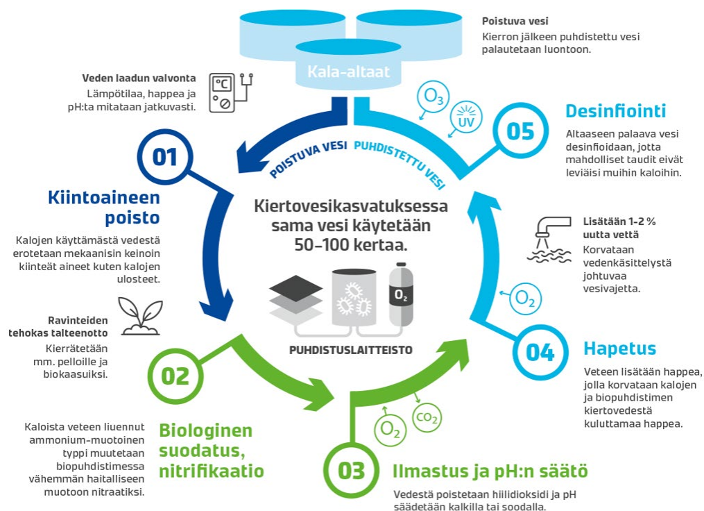
Kuva 1. Kalan kiertovesikasvatuksen prosessi
