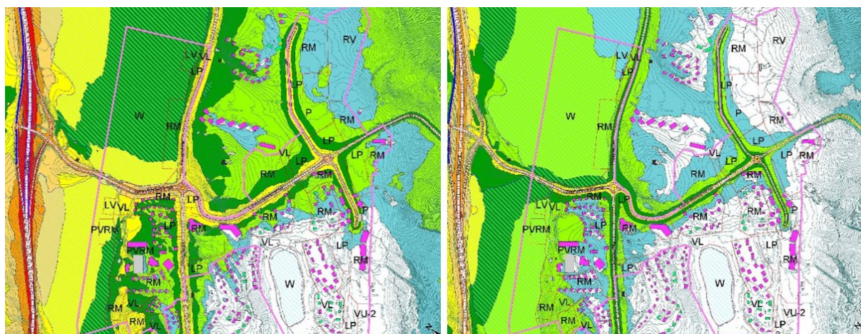
Kuva 28: Tieliikenteen melumallinnus ennustetilanteessa vuonna 2050. Vasemmalla päiväajan ja oikealla yöajan keskiäänitasot.
